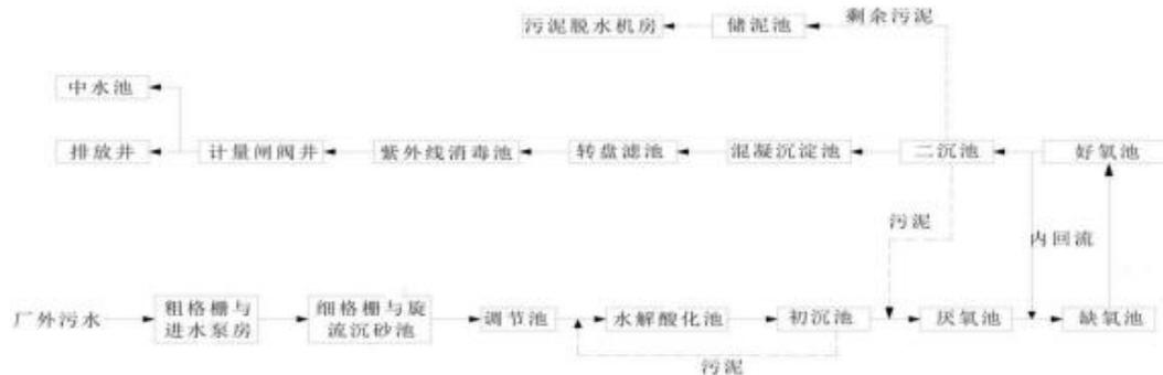
图 4-3 滨海工业园污水处理厂工艺流程图
